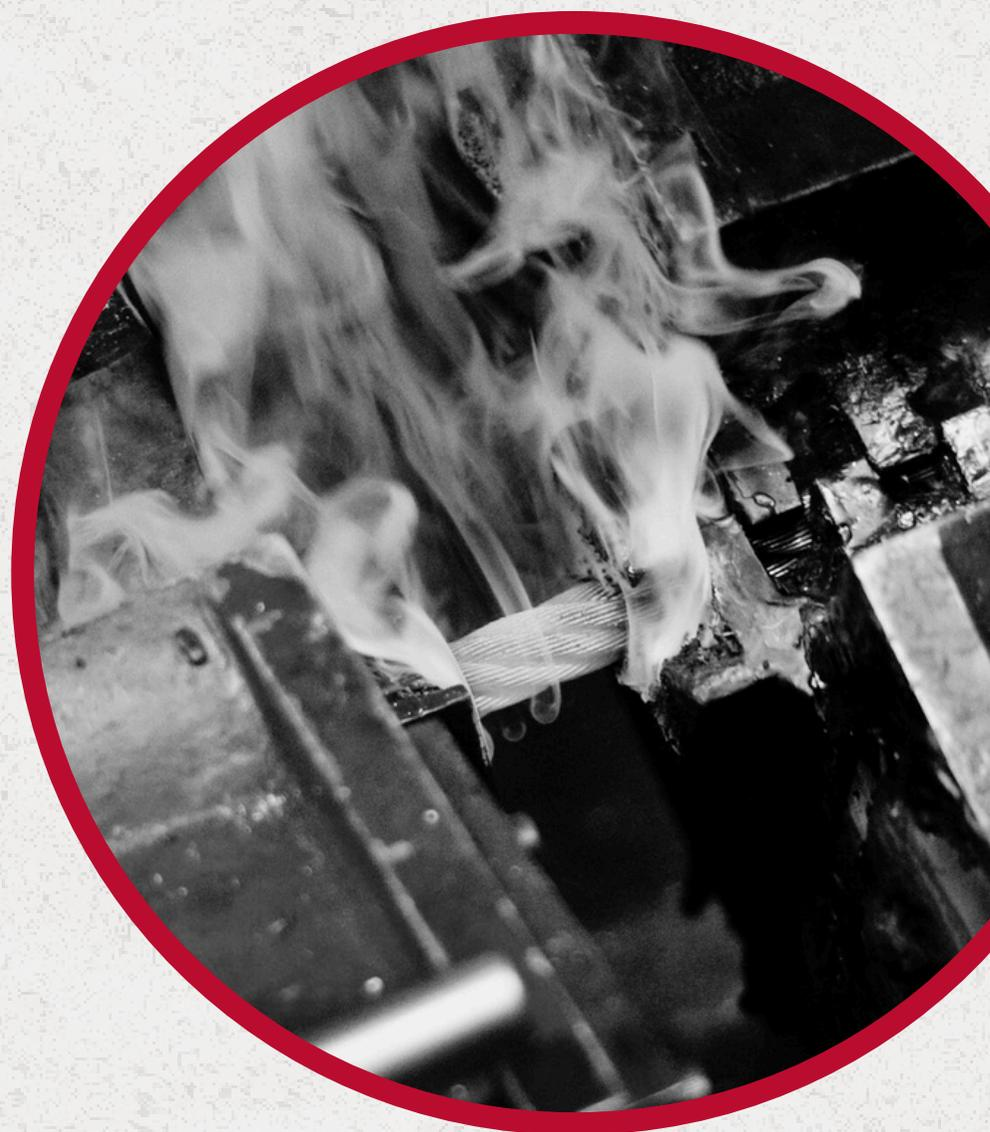
Preferiblemente, el corte del cable debe realizarse utilizando un cortador de disco abrasivo de alta velocidad.
