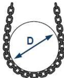
Fig. (5 y 6). Reducción de la carga máxima de utilización por bordes afilados y diámetros de apoyo reducidos.
