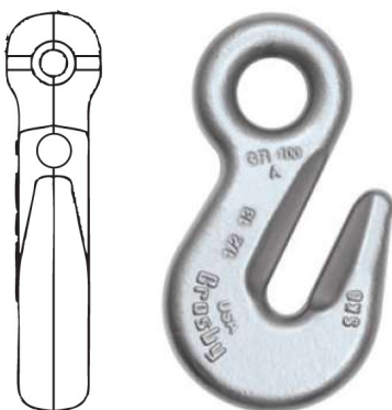
Fig. (8). modelo de acortador Crosby A-1328. Su uso requiere una reducción del 20% respecto a la WLL nominal de la eslinga.
