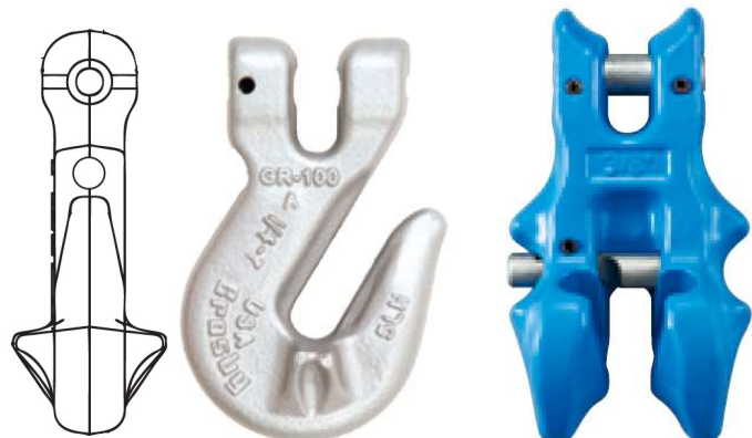
Fig. (9). modelos de acortadores con diseño mejorado. Permiten su uso al 100% de la capacidad de la WLL marcada.
