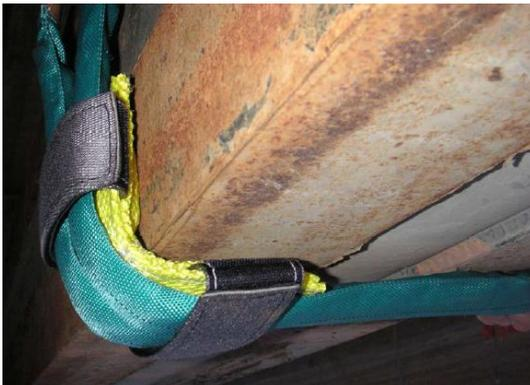
**Foto 1.** – Ejemplo de protección adicional de la eslinga sintética contra bordes afilados.
