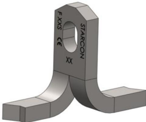
El anclaje de pie plano STA-F es adecuado para su uso en placas. La cabeza del anclaje tiene un orificio en el que se monta el perno de bloqueo de la argolla de elevación. Se debe colocar un refuerzo adicional por encima del pie del anclaje.
