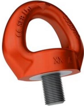
El cáncamo de elevación SEB es un anillo giratorio único. Equipado con 2 pasadores que lo guían siempre perfectamente en la dirección de la eslinga. Está especialmente diseñado para la elevación, incluidas las cargas giratorias.
